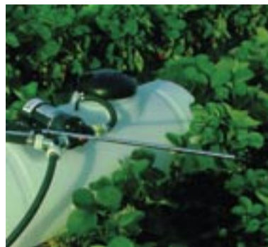
Flojet Duplex II -pumppulla tuotto on 8,3 litraa minuutissa.
